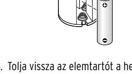
3. Tolja vissza az elemtártó a helyére (a + jelöléseknek látszódni kell), nyomja rá a fedelel és forgassa el 90°-kal az óramutató járásával megegyező irányba (ON nyílirány).
